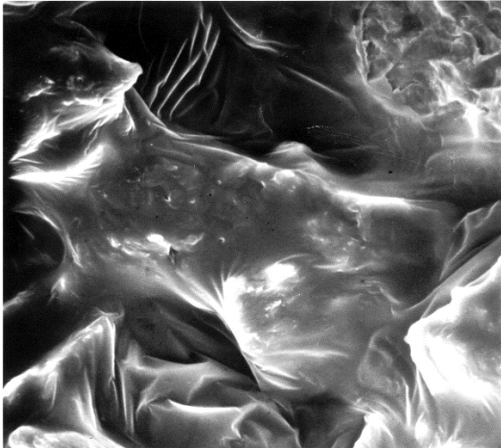
KCl- tablet, 10 kN Kötőanyag: Avicel PH 101
